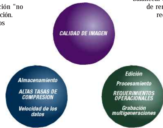
Figura 1 SISTEMAS DE COMPRESION Cualquier sistema de compresión de video digital debe balancear tres criterios de rendimientos demandantes.
